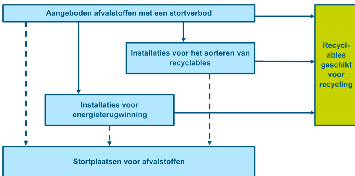
Figuur 1.1 Schematische weergave afvalverwijderingsstructuur voor afvalstoffen met een stortverbod
