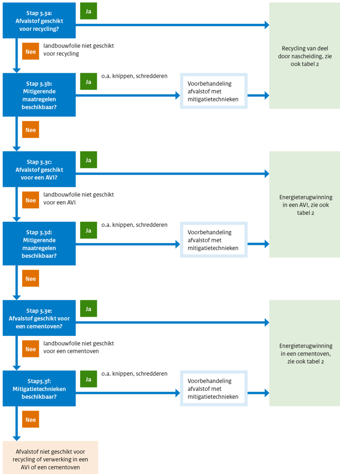
Figuur 3: Doorlopen van het stappenplan van paragraaf 7.4.2 van deze leidraad voor landbouwfolie
