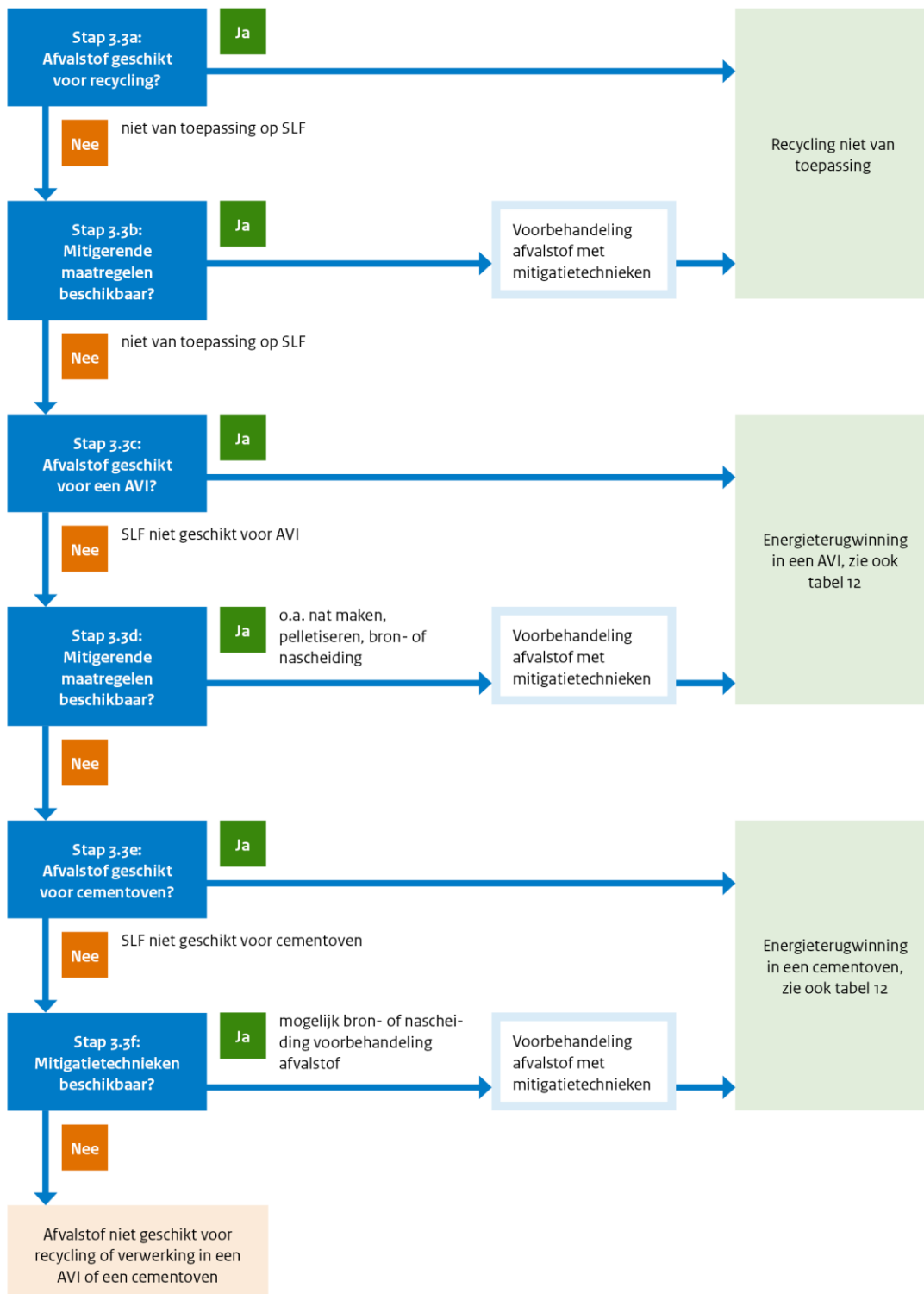
Figuur 8: Doorlopen van het stappenplan van paragraaf 7.4.2 van deze leidraad voor de lichte fijne fractie bij metaalshreddering (SLF)
