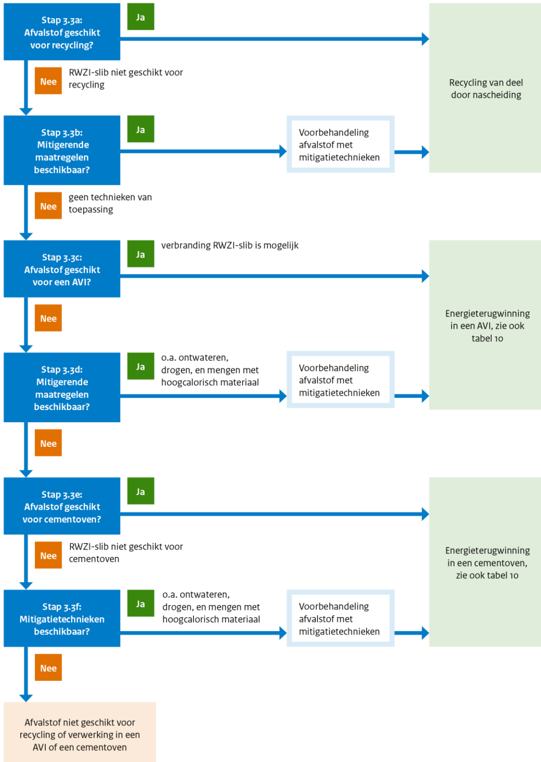
Figuur 7; Doorlopen van het stappenplan van paragraaf 7.4.2 van deze leidraad voor RWZI-slib
